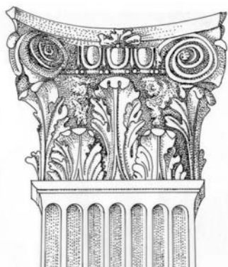
Ryc. 8. Fragment pilastru z Sali Gwardii Konnej Koronnej – na głowicy widoczne dwa rzędy stylizowanych liści akantu. (Rys. H. Galera).
